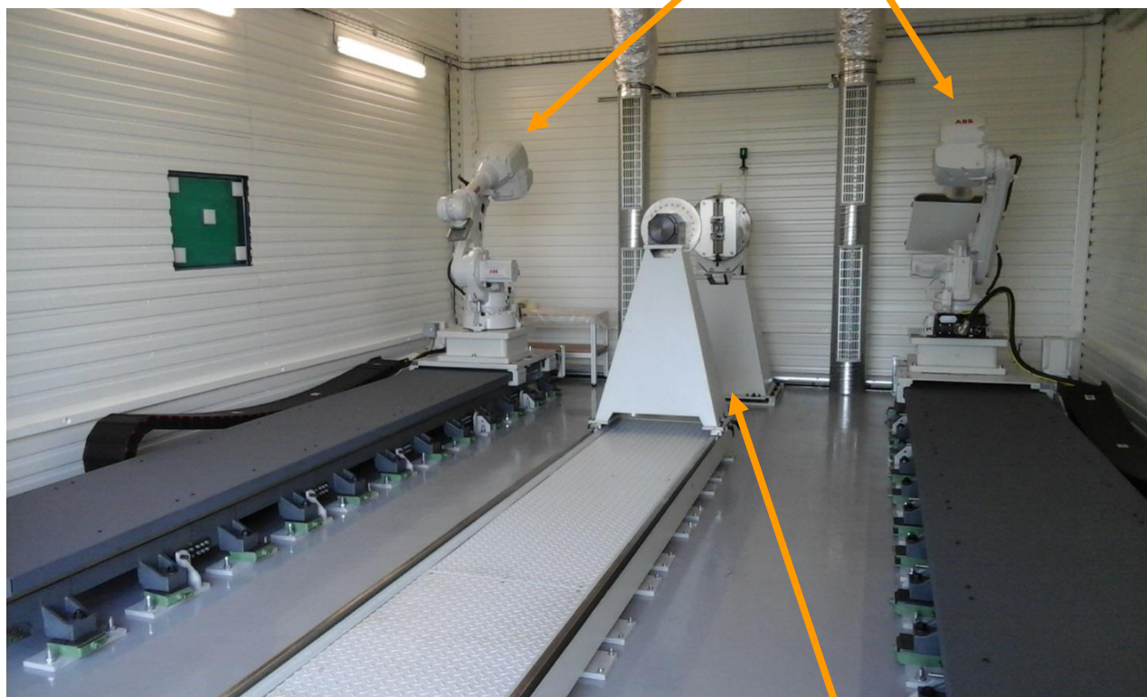
Un positionneur composé de 2 poutres à tête rotative
