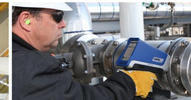
Les différents alliages présentent différentes propriétés, notamment leur tolérance aux températures élevées, leur résistance à la corrosion et leur durabilité. Comme il est difficile de différencier ces alliages visuellement, les inspecteurs utilisent les analyseurs XRF portables Vanta pour l'identification positive des matériaux.
