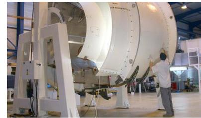
*Inspection par Thermographie IR active d'un capot de moteur*
