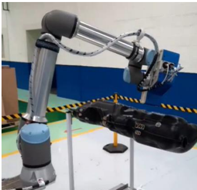
Inspection robotisée par mesure d'épaisseur THz
