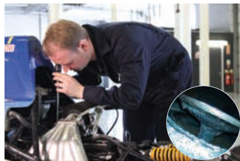
Contrôle des composants d'un moteur au moyen d'un endoscope
