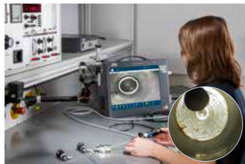
Contrôle de composants industriels au moyen d'un endoscope et de l'unité de documentation TECHNO PACK® T LED
