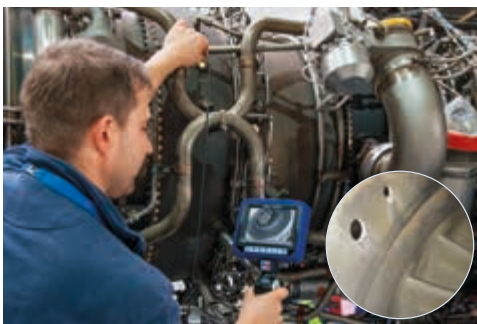
Contrôle d'une turbine d'avion au moyen du vidéo-endoscope MoVeo
