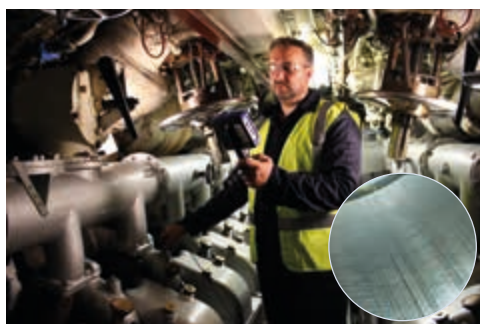
Contrôle d'un moteur de sous-marin au moyen du vidéo-endoscope MoVeo
