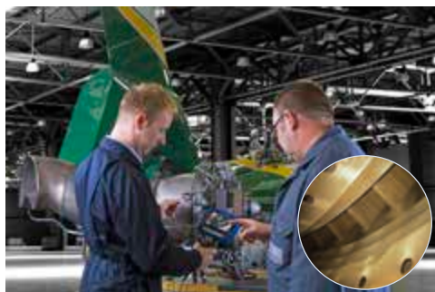
Contrôle d'un moteur d'hélicoptère au moyen du vidéo-endoscope MoVeo
